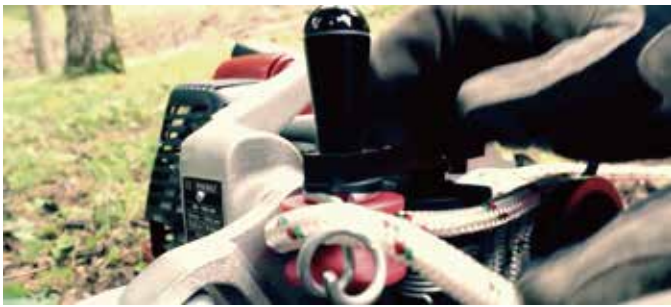
⑤ロッドワインダー (螺旋の針金) にロープを通す。 ⑥完了
