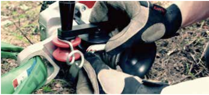
③ロープを黒いリールに添わせ、V字カット を使い下に逃がしておく。
