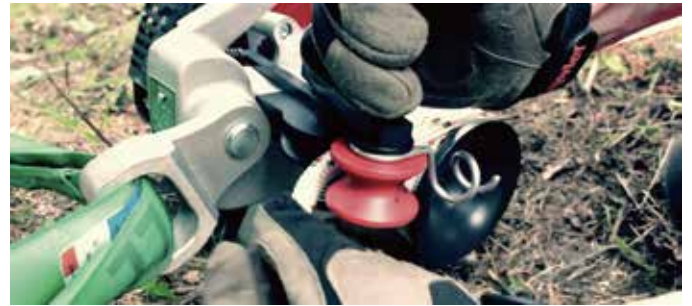
④赤いリールのレバーを手前に引き、ロープを 奥へ通してから、レバーを戻す。
